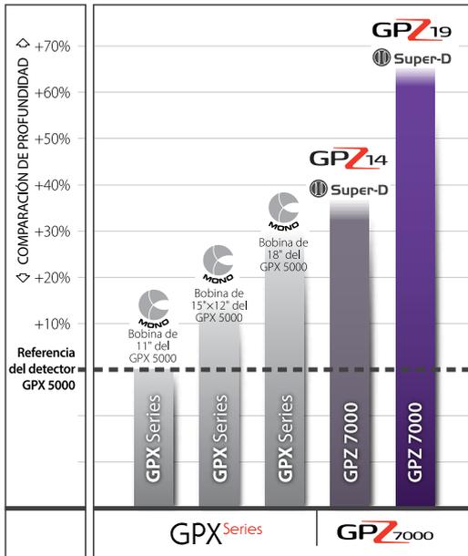
En un terreno mineralizado y con hierro, un detector GPZ 7000 con una bobina GPZ 19 logrará resultados mucho mejores que un detector de la serie GPX con cualquier tamaño de bobina Commander. En un terreno muy salado, la bobina GPZ 14 puede dar mejores resultados que la bobina GPZ 19. | Consulte en [www.minelab.com](http://www.minelab.com) o en la caja del producto para obtener más detalles.
